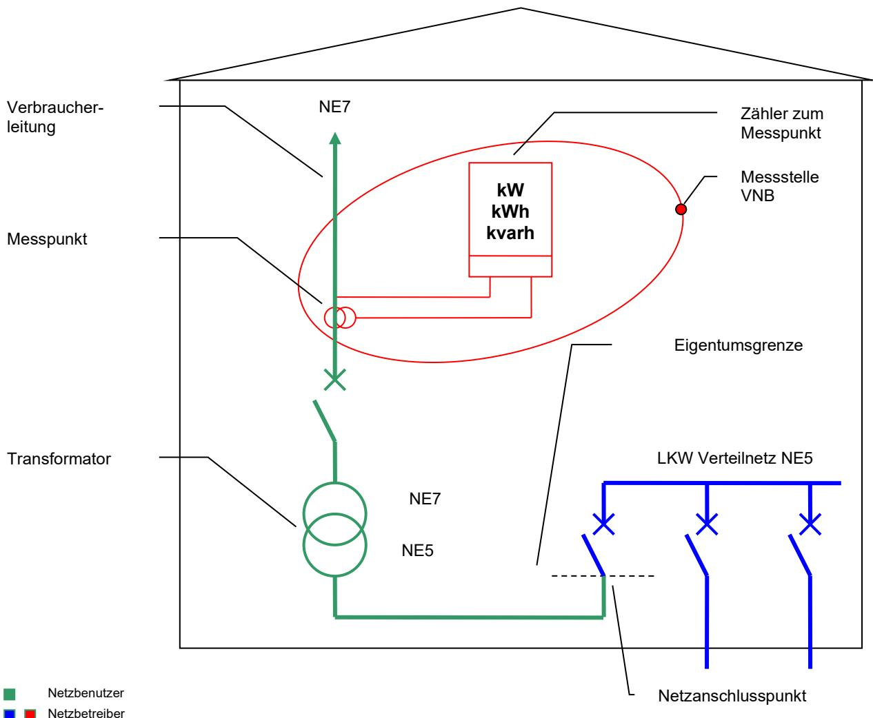
Im Standardfall sind die Spannungsebene der Entnahmestelle und der Messung identisch und liegen beide im Mittelspannungsnetz (siehe Kapitel 3.1.3).
